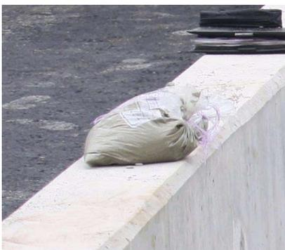
Die in etwa immer gleiche Menge des zu prüfenden Betons wird in einem verschlossenen Plastikbeutel unter realen Umgebungsbedingungen gelagert. Durch Kneten des Beutels in Zeitabständen von ca. 15 Min. lässt sich der Erstarrungszustand des Betons beurteilen.
