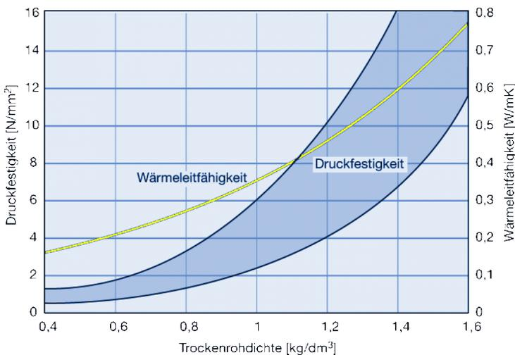
Porenbeton/ Schaumbeton hat eine weiche bis fließfähige Konsistenz. Er ist pumpbar und erfordert keine Verdichtung. Durch den hohen Luftporengehalt ist Porenbeton gut wärmedämmend. Festigkeit und Wärmeleitfähigkeit sind über die Rohdichte steuerbar. Schwinden und Kriechen nehmen mit abnehmender Rohdichte zu.
